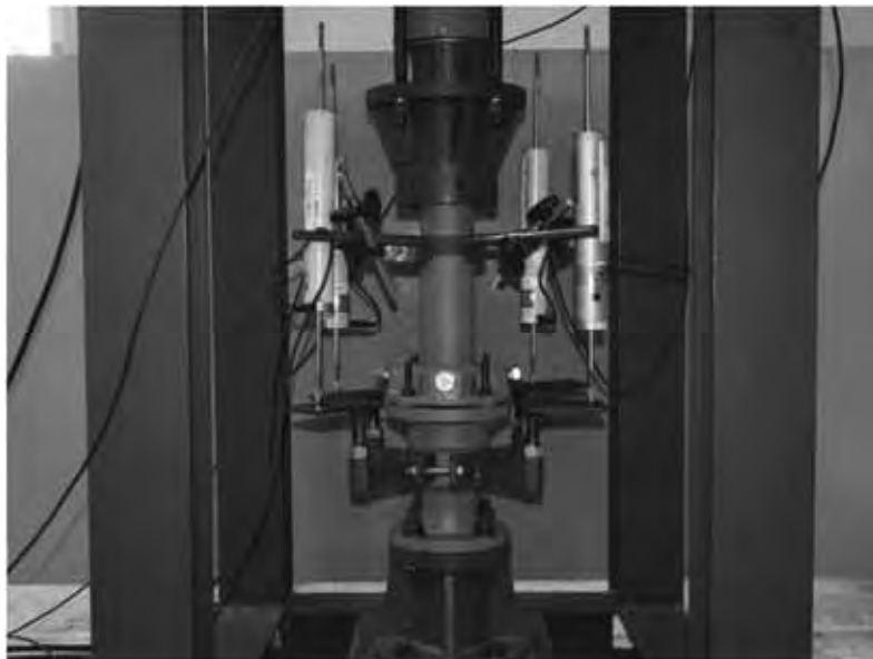
写真 7 離脱防止性能試験状況(異形管)
