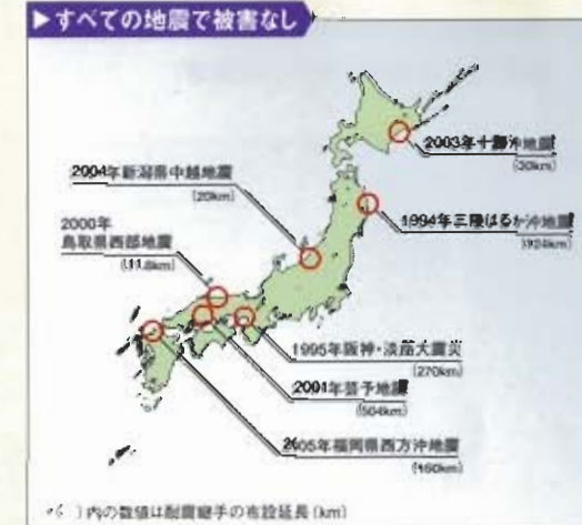
過去の大規模地震におけるS・SII・NS形の布設状況
